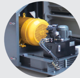
Hidrolik Güç Ünitesi
