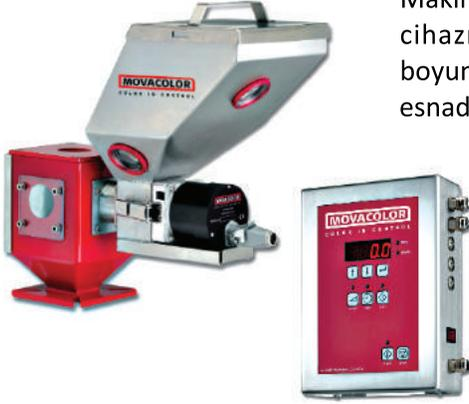
Makine malzeme akış boğazına bağlanan MC-12 volümetrik dozajlama cihazı belirlenen RPM'de çalışacaktır. Burada mal alma süresi boyunca renk katımı sağlayabilir ya da mal alma sinyali aktif olduğu esnada belirlenen süre boyunca dozajlama yapılır.
